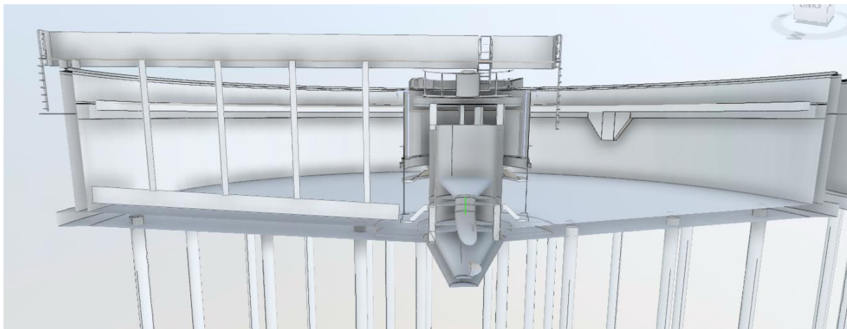
Abbildung 18: Schnitt durch ein Nachklärbecken
